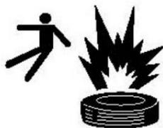
**Ne pas tenir compte de ces consignes de sécurité peut causer une rupture du bourrelet et l'explosion de l'ensemble, dégageant une force suffisante pour causer des blessures graves ou la mort.**
