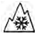
**Bien que les pneus toutes saisons soient conçus pour offrir une performance convenable dans certaines conditions hivernales, l'utilisation de quatre (4) pneus d'hiver est recommandée pour une performance optimale. Les pneus d'hiver recommandés pour utilisation dans des conditions hivernales rigoureuses sont marqués sur au moins un flanc des lettres M et S et sont également marqués d'un pictogramme représentant un flocon de neige dans une montagne.**
